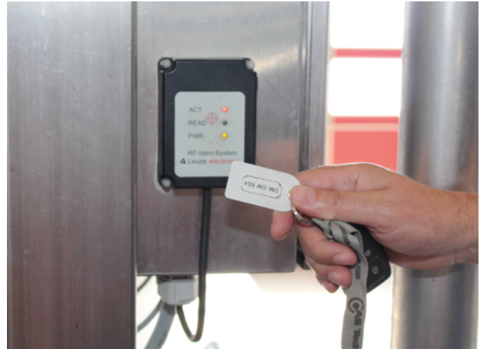
Den Schlüssel für eine durchgängige Rohstoff-Verfolgung liefert der Einsatz von RFID-Technologie
